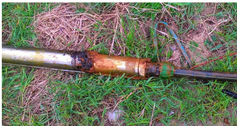
3.2. ábra: A vizsgálatok alapjául szolgáló biofilm minta (saját felvétel)
