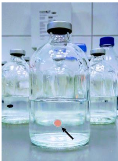
3.4. ábra: Az oldott oxigén koncentrációjának nyomon követésére alkalmazott érzékelő szpot (saját felvétel)
