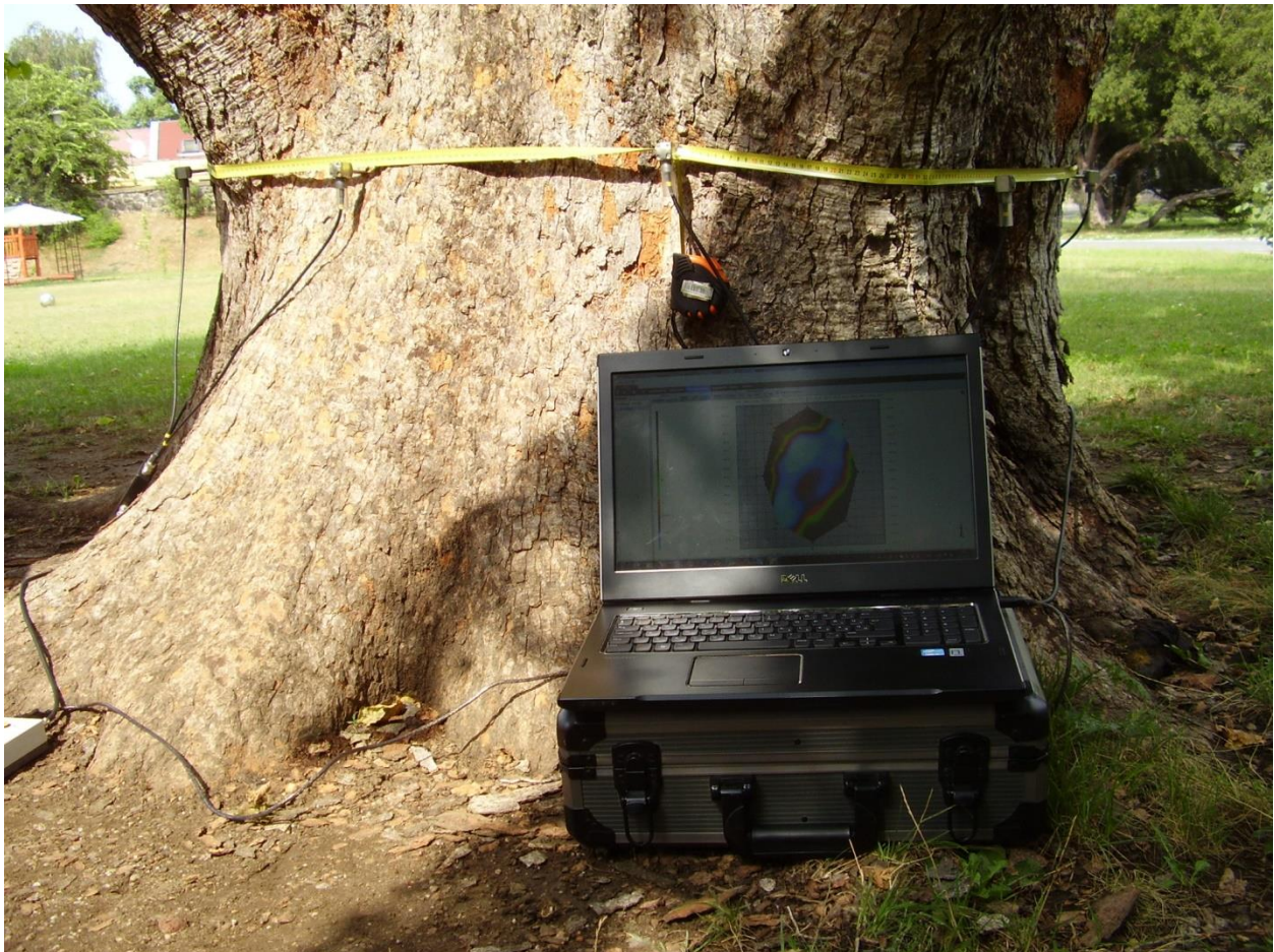
13. ábra: A gyöngyösi törökmogyoró mérése tomográffal (Takács, 2012)
